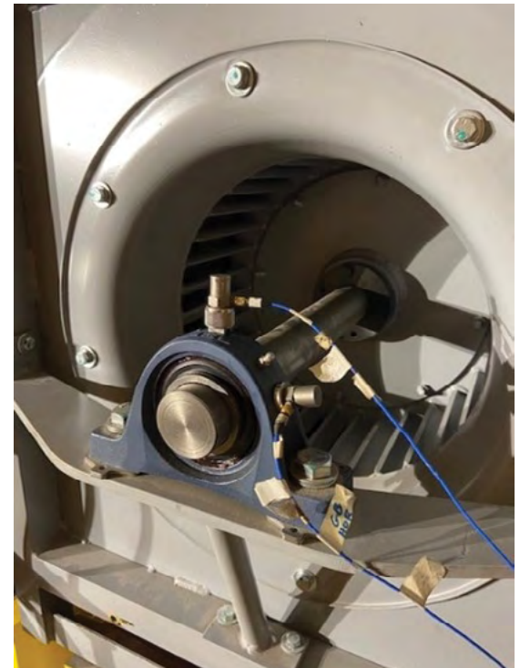
Figure 2: Accéléromètres temporaires montés sur le boîtier du palier extérieur du ventilateur
