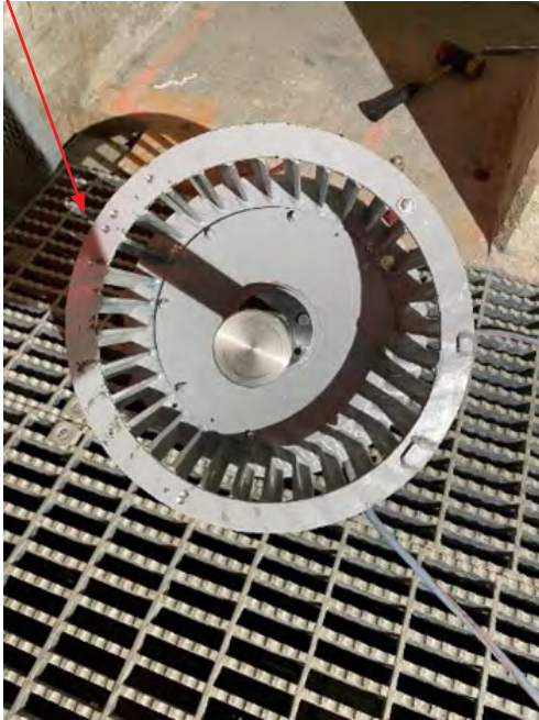
Figure 14: Pales du ventilateur de frein conçues avec la rotation de l'arbre.
